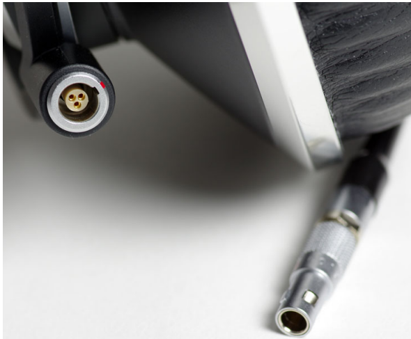
Kabel nehmen über Lemo-Stecker Kontakt zum AKG K872 auf
